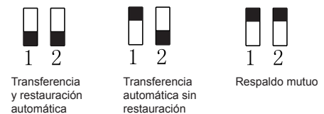
Configuración del modo de funcionamiento
